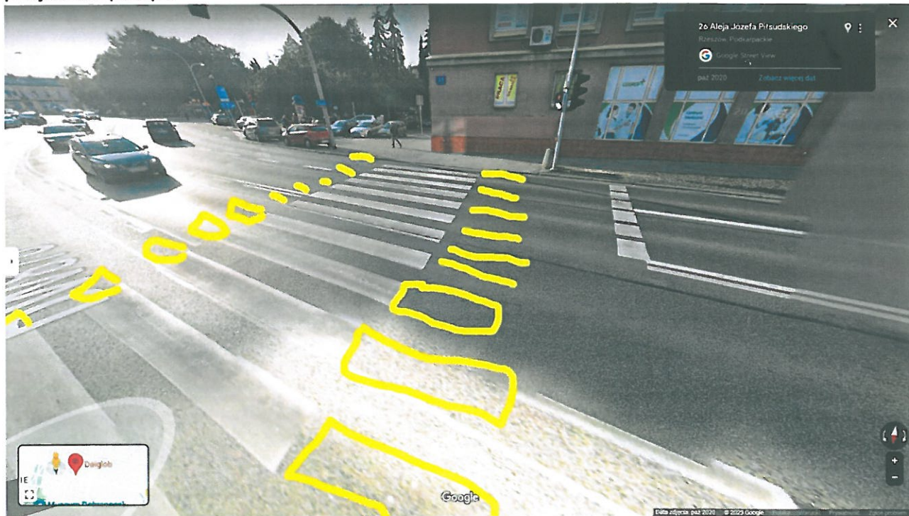
Rysunek 5 Zdjęcie google - poszerzyć przejście dla pieszych ponieważ w szczycie porannym i popołudniowym natężenie ruchu pieszego jest tak duże że piesi zwyczajnie nie mieszczą się w wyznaczonych pasach. Należy domalować po obu stronach brakujące pasy tworząc szersze przejście
